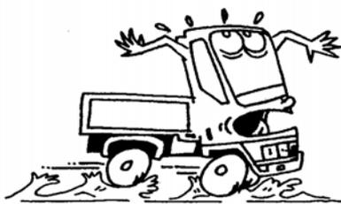
ハイドロプレーニング現象とは，水のためた路面を高速走行するとき，一定速度以上になるとタイヤが路面から浮き上がり，水上を滑走する状態になって車が操縦不能になる現象をいいます。
