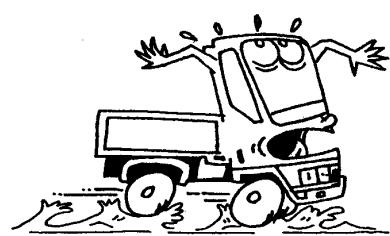
ハイドロプレーニング現象とは、水のたまつた路面を高速走行するとき、一定速度以上になるとタイヤが路面から浮き上がり、水上を滑走する状態になって車が操縦不能になる現象をいいます。
