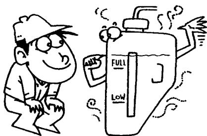
冷却水量の点検はエンジンを始動する前に行います。冷却水温が高いと温度による水の膨張で水量が実際より多くなります。
